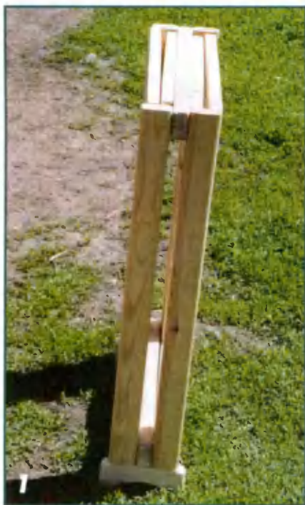
Основание стола-книжки из брусков сечением 28х55 мм.
